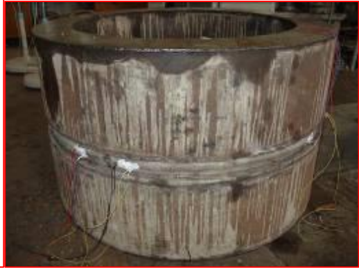
图 5 竖向可缩性井壁结构模型
