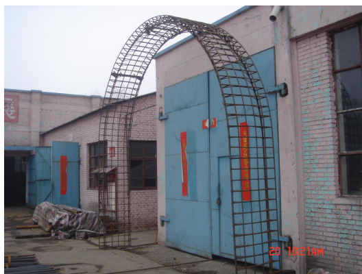
图 12 工厂加工的网壳支架
