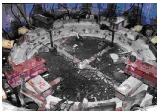
图 6 高强高性能钢筋混凝土井壁
