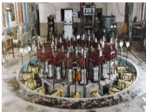
图 8 双层钢板高强混凝土复合井壁
