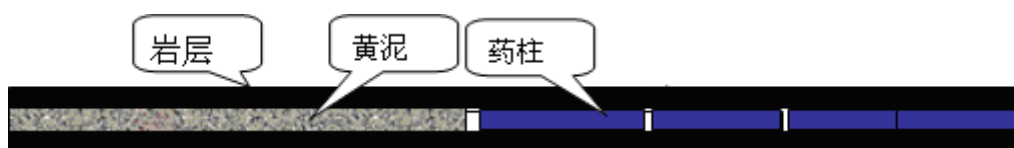
图 19 装药与封孔结构示意图
